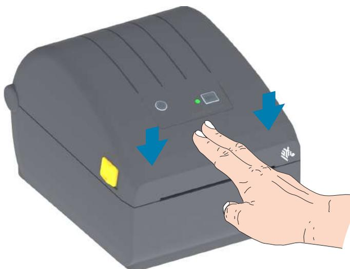
プリンタを用紙にキャリブレーションする必要がある場合もあります。プリンタのセンサーは、ラベル、ライナーおよびラベル間の距離を検知して正常に動作するように調整する必要があります。同じ用紙サイズ、ベンダーおよびバッチ)を再装着したときは、フィード(前送り)・ボタンを1回押して用紙の印刷準備ができます。
