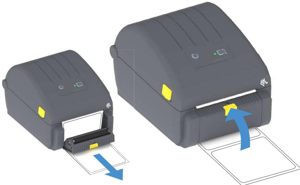
5. ラベルが露出して取り出せるようになるまで、フィード (前送り) ・ ボタンを複数回押して放します。
