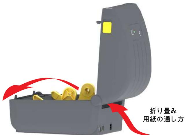
2. 用紙ガイドの停止位置を金色のつまみを使って調整します。折り畳み用紙を1枚使って停止位置を設定してください。用紙ガイドの幅を広げるには、つまみを向こう側に回します。用紙ガイドの幅を狭くするには、つまみを手前に回します。
