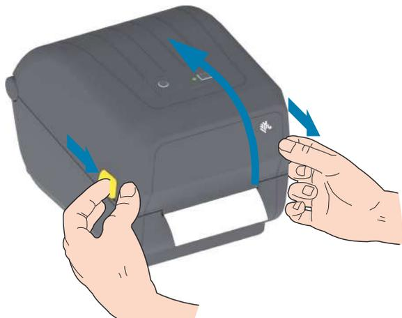
2. 用紙ロール・ホルダーを開きます。ロール紙がプラテン (ドライブ)・ローラーを通るとき、印刷される面が上向きになるように用紙ロールの向きを定めます。用紙ガイドを空いている方で引いて開き、用紙ロールをロール・ホルダーに載せたらガイドから手を放します。ロールがスムーズに回転することを確認します。ロールが用紙セット部の底で動かない状態になってはなりません。
