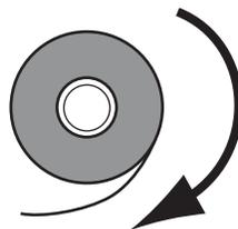
3. リボンのロールをリボン・サプライ・スピンドルにセットします。ロールを一番奥まで押します。
